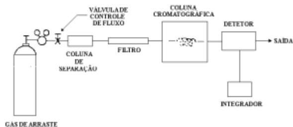
Figura 3 - Diagrama esquemático do cromatógrafo que mede a concentração do CO.
