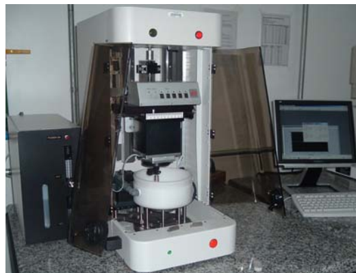
FIGURA 2.6: Equipamento tribômetro utilizado para as medidas de atrito.
