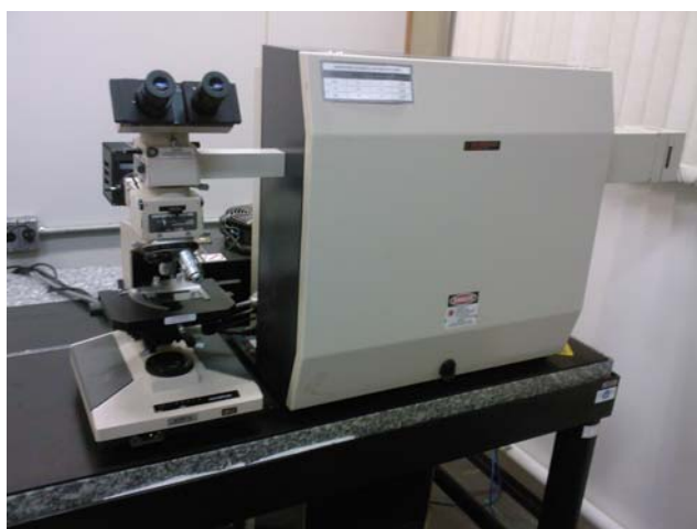
FIGURA 2.3: Sistema para espectroscopia Raman Renishaw 2000 do LAS/INPE.
