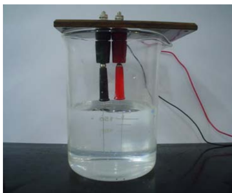
FIGURA 3.1: Sistema para a eletrodeposição da prata.
