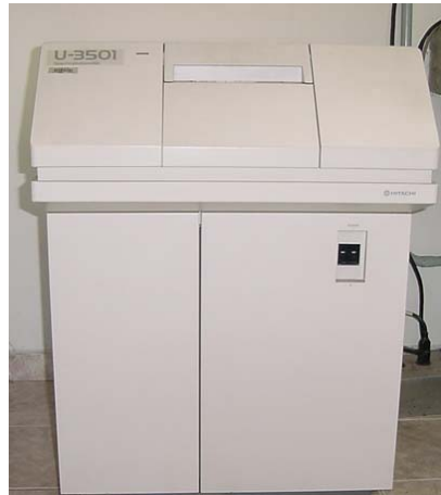
FIGURA 2.1: Espectrofotômetro UV-Vis modelo U-3501 (Hitachi) do LAS/INPE.
