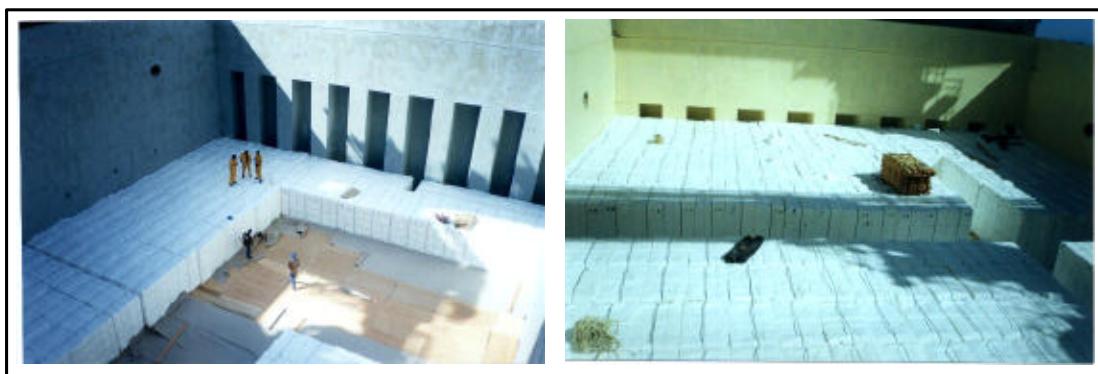
FIGURA 5.11 – Estivagem de unidades de celulose em porões de navios
