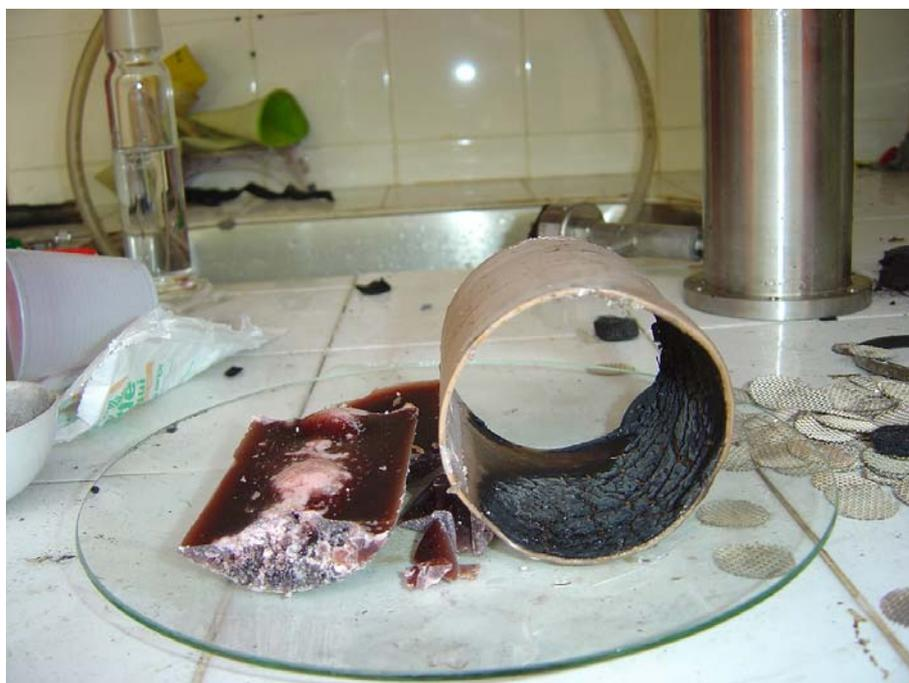
Figura 3.21 – Parafina residual e cartucho de PVC após teste.
