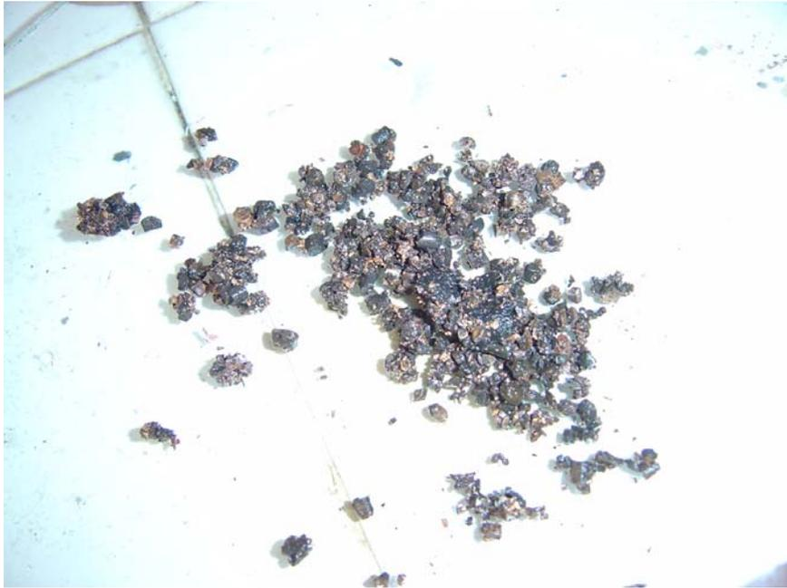
Figura 3.17 – Catalisador de óxido de manganês suportado em alumina retirado do leito catalítico após o teste.
