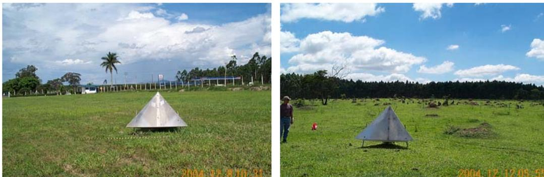
FIGURA 3.7 – Fotos de dois *corners reflectors* instalados na área de estudo.
