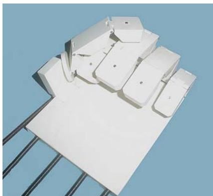
Figura 8: Foto da prótese robótica em teste de flexão e extensão dos dedos
