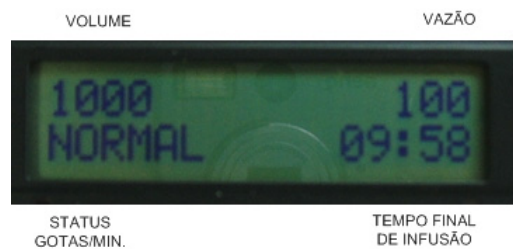
Figura 4: Foto do painel da bomba de infusão em funcionamento
