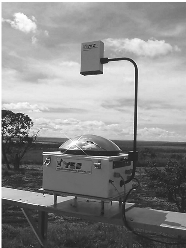
Figura 6 - Imageador TSI 440 em uso nas estações da rede de coleta de dados SONDA (Sistema de Organização Nacional de Dados Ambientais).
