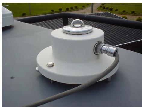
Fig. 4.12– Radiômetro UV-B MS-210 W instalado no OES/CRSPE/INPE – MCT, obtido a partir da cooperação Brasil – Japão.
