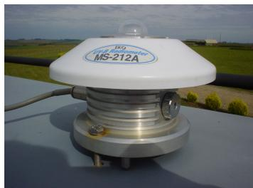
Fig. 4.14 – Foto do Radiômetro UV-A MS – 212. Equipamento obtido através da cooperação Brasil – Japão.
