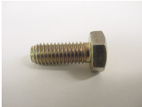
FIGURA 3.2 - Parafuso com superfície revestida pelo processo de bicromatização.
