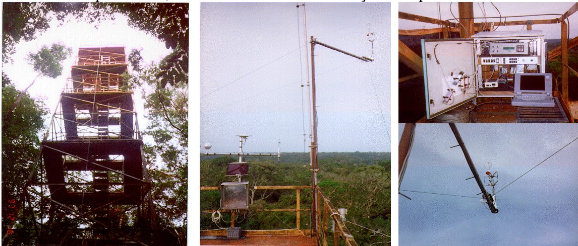
Figura 1 – À esquerda, vista da torre de 45 m de altura pertencente ao INPA, instalada na área experimental da Bacia do Rio Tarumã-açu, próxima à Manaus, no centro, um anemômetro sônico montado no topo da torre. À direita, em cima, o analisador de gás infravermelho LI6262 dentro do abrigo, que contém ainda os frascos de produtos químicos (percloro de magnésio e soda
