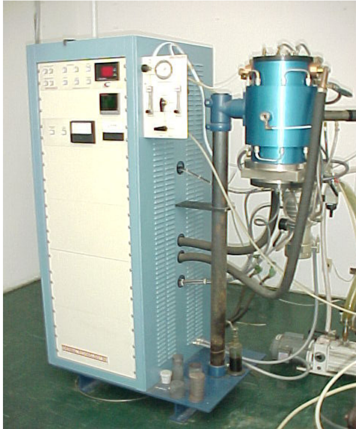
Figura 3.1 – Imagem do forno tipo ASTRO utilizado na AMR/CTA para a hidrogenação e sinterização dos compactos de titânio.
