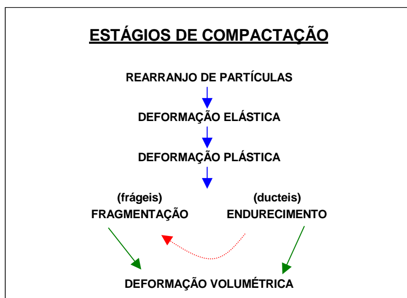
FIGURA 2.6 - Fluxograma do processo de compactação por prensagem, mostrando as diferenças nos comportamentos dos pós dúcteis e frágeis.
