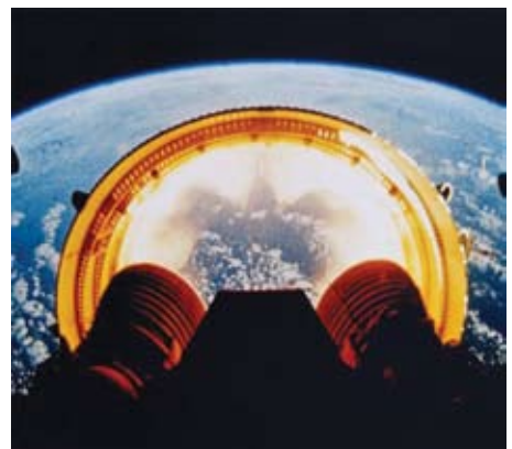
O Anel de separação se desprende do segundo estágio do Saturno V.
