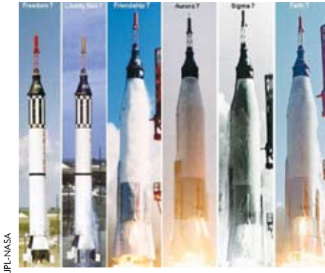
Lançamentos dos foguetes que conduziram os 7 astronautas do Programa Mercury – os dois primeiros, em vôos suborbitais, usaram o lançador Redstone, enquanto os três últimos, que foram orbitais, usaram o lançador Atlas.
