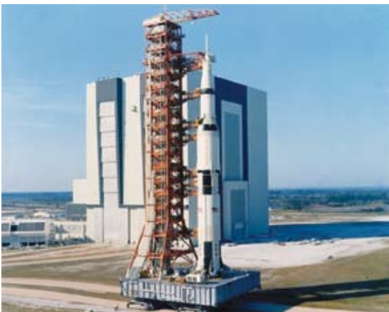
Saturno V sendo conduzido do prédio de integração e testes para a plataforma de lançamento. Ao fundo, se tem o prédio de integração e testes, onde o Saturno V é testado, integrado e posicionado em sua configuração de lançamento.
