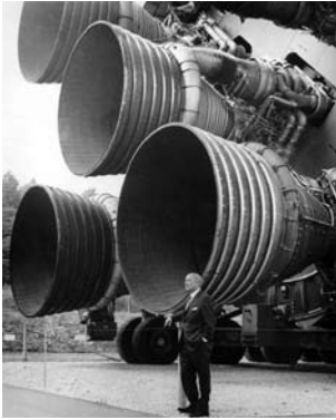
Motores F-1 do primeiro estágio do foguete Saturno V comparados à estatura de seu criador, Werner von Braun.
