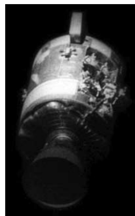
Visão dos danos no módulo de serviço da Apollo 13, fotografado pela escotilha do Módulo de Comando após a separação.
