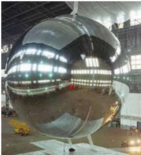
Echo 1 – lançado em 1960 foi o primeiro satélite de comunicações. Era capaz de transmitir 12 ligações telefônicas simultaneamente ou um canal de TV.
