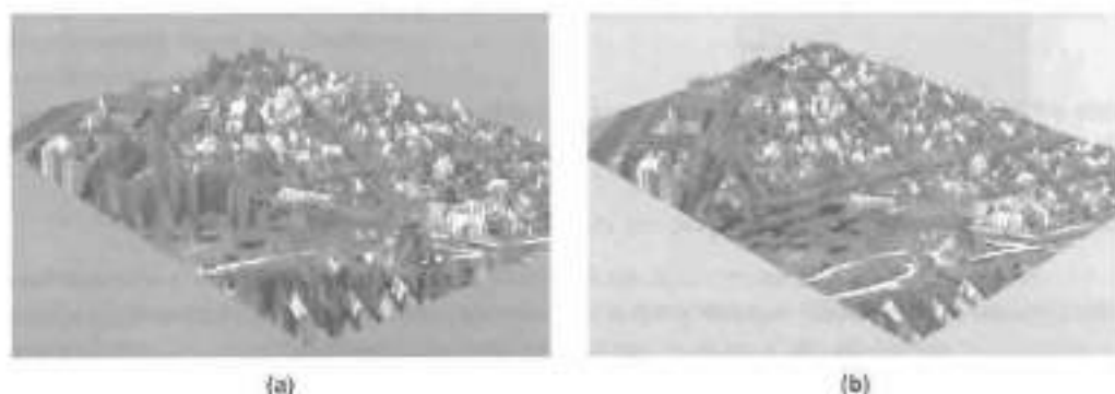
Fig. 18.1 Modelos tridimensionais com textura derivada de imagens Quickbird (a) original; e (b) após a exclusão da vegetação (Miqueles e Centeno, 2004)
