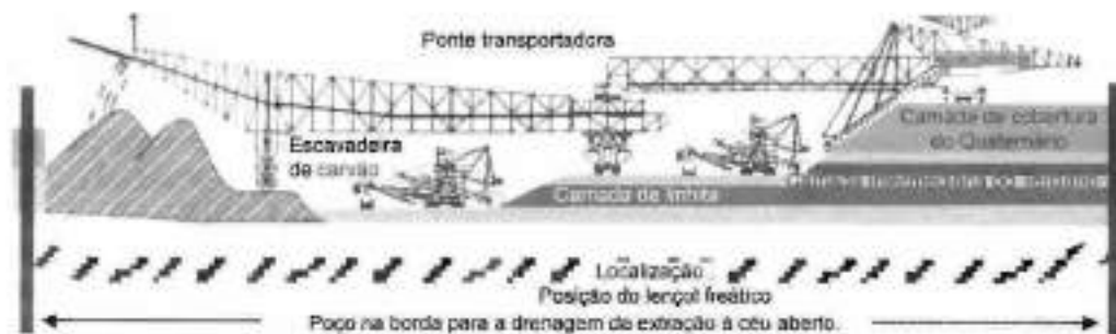
Fig. 6.1 Exploração a céu aberto de linhita empregando tecnologia de ponte transportadora.
