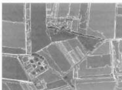
Fig. 13.4 Segmentação de dados de uma foto aérea digital, com dados SIG (software eCognition)
