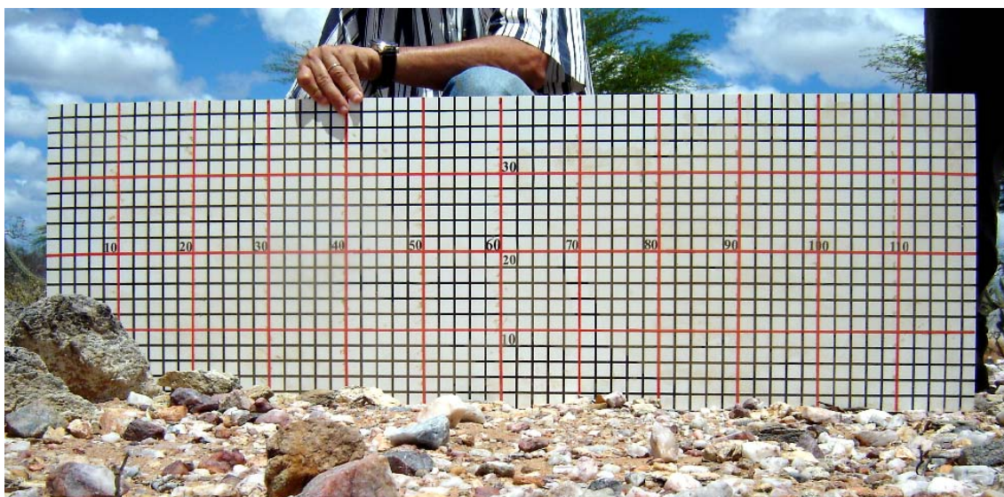
Figura 5.1: Rugosímetro. Exemplo de medida tomada sobre a unidade do quartzo feldspato gnaiss (Ponto 72).
