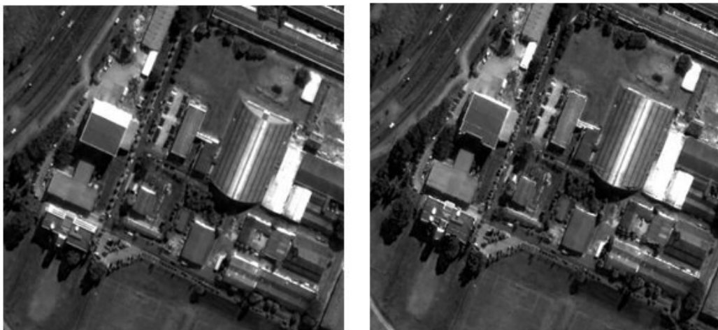
Figura 9 - Correção geométrica de imagem Quickbird com a transformação projetiva e dados laser scanner: a) original; b) ortofoto (Araki et al., 2005).
