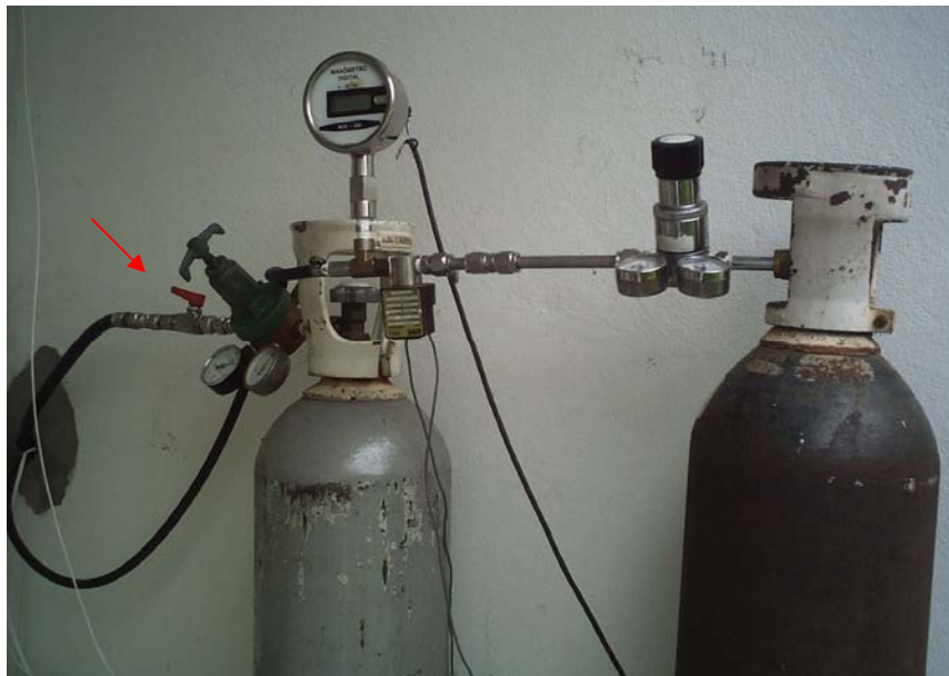
FIGURA 5.7 – Posicionamento dos cilindros ar e O_2 (a seta indica a válvula manual)
