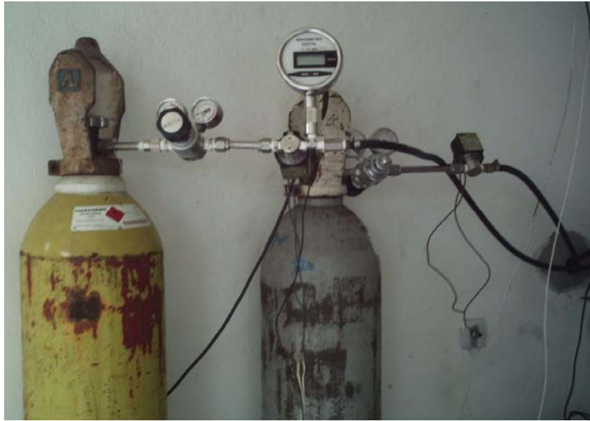
FIGURA 5.6 – Posicionamento dos cilindros H_2 e N_2
