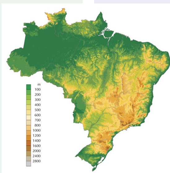
Figura 10. Imagem de relevo gerada por interpolação (vizinho mais próximo) da base de dados GTOPO30.
