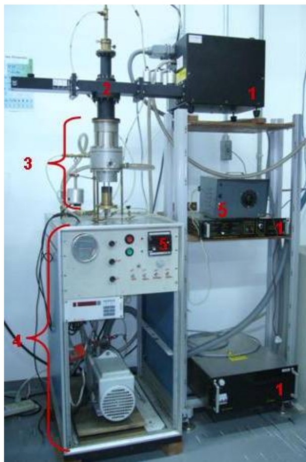
Figura 5.2: O reator de microondas: 1) gerador de microondas; 2) acoplador do guia de onda retangular para a cavidade cilíndrica; 3) câmara; 4) sistema de vácuo e 5) sistema de aquecimento.
