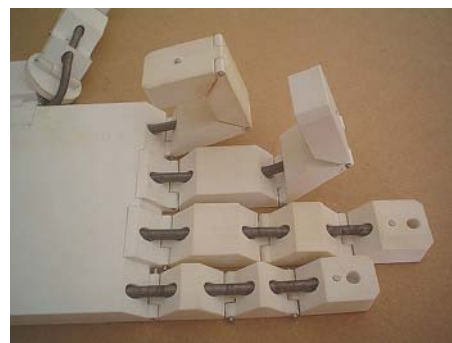
Figura 3: Mão mecânica da prótese robótica
