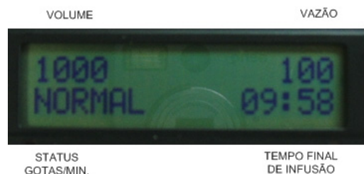
Figura 4: Foto do painel da bomba de infusão em funcionamento
