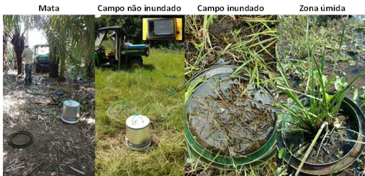
Figura 2. Medidas de fluxo de gases com câmaras estáticas e anéis de vedação.
