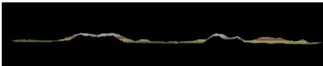
Figura 8 –Transecto falso positivo quando a presença de ruídos devido ao uso do algoritmo “findnoisyclouds.py” em regiões de relevo acentuado.
