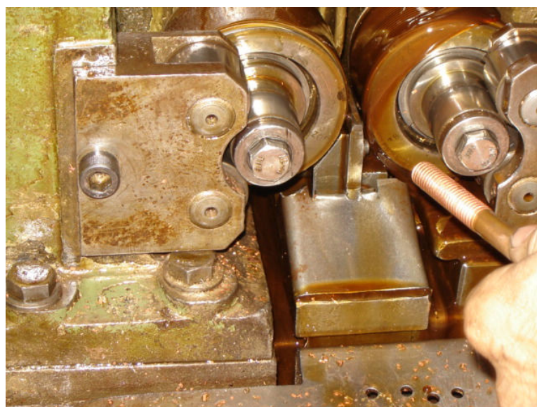
FIGURA 1.3 - Equipamento de fabricação de elemento roscado por conformação a frio.
