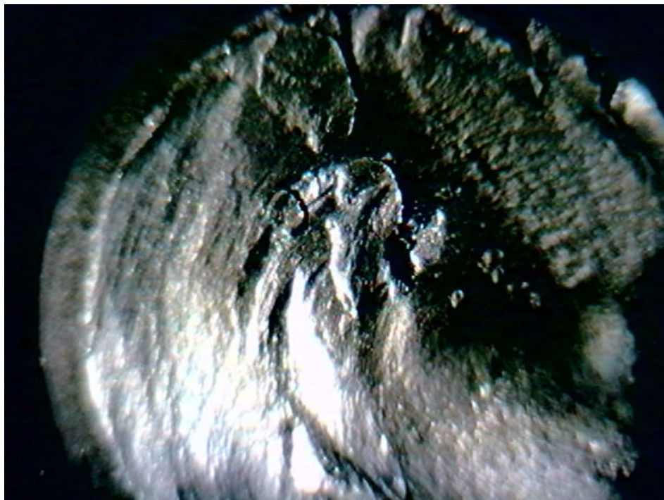
FIGURA 2.9 - Região de ruptura ocorrida no ponto onde se previa a maior concentração, observa-se que a ruptura ocorreu por esforço de torção.
