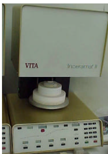
FIGURA 3.3 - Forno utilizado para infiltração do vidro e sinterização das cerâmicas.
