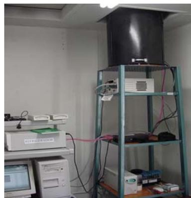
**Figura 4.4:** a) Instalações do imageador 1 e 2 em a) *São José dos Campos* (UNIVAP) e b) *Brazópolis* (LNA). c) Imageador *all-sky* e seus elementos principais; d) Equipamento em operação no LNA: Imageador, fonte refrigeradora, computador, unidade eletrônica.
