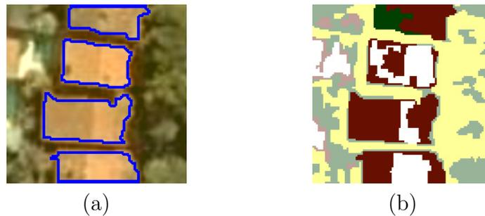
Figura 3.11 - Separação de telhados em classes diferentes: a) imagem original com telhados em destaque e b) telhados separados em classes diferentes.
