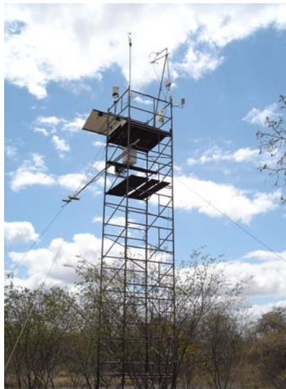
Figura 3.4 – Torre micrometeorológica instalada na área da Embrapa Semi-Árido em Petrolina, PE.
