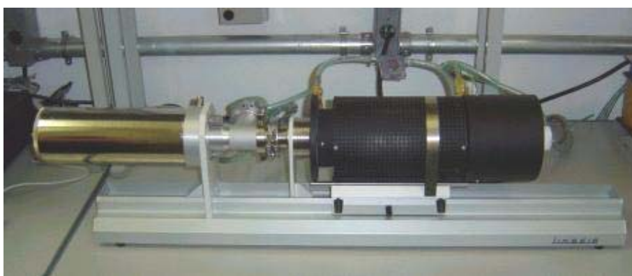
FIGURA 3.7 - Dilatômetro Linseis L75 pertencente ao LaCCeF – FCT/UNESP
