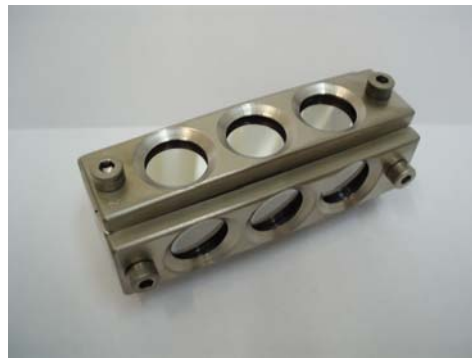
FIGURA 4.3 – Imagem do porta-amostras com capacidade para 12 amostras de 15 mm de diâmetro.
