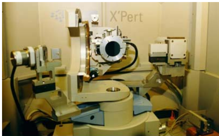
FIGURA 3.2 – Difratômetro de raios-X de Alta Resolução Philips X'Pert MRD do LAS/INPE.
