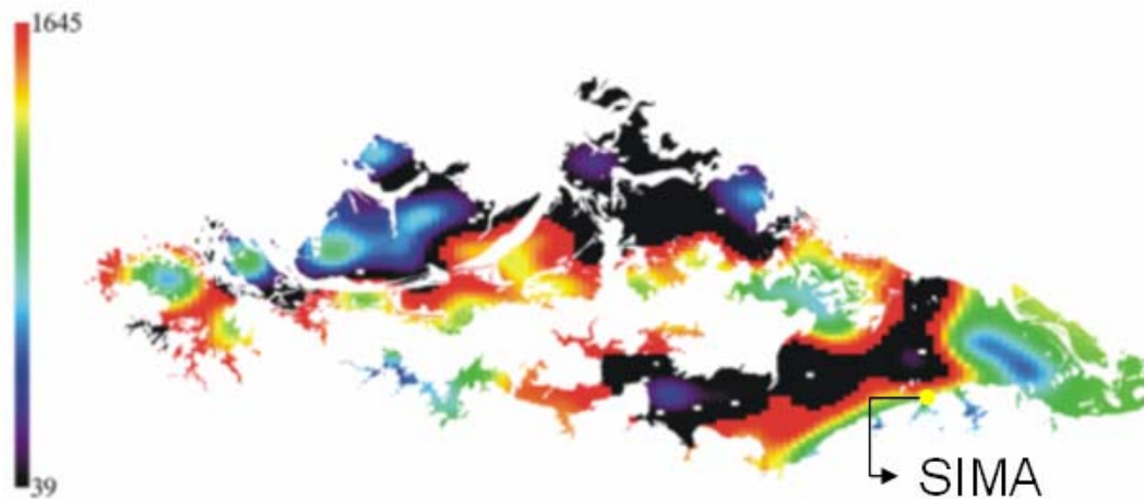
FIGURA 4.7: Distribuição da turbidez (NTU) na planície de Curuaí através da krigagem ordinária.
