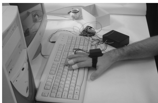
Figura 4 – Mão instrumentada mostra o posicionamento dos sensores
