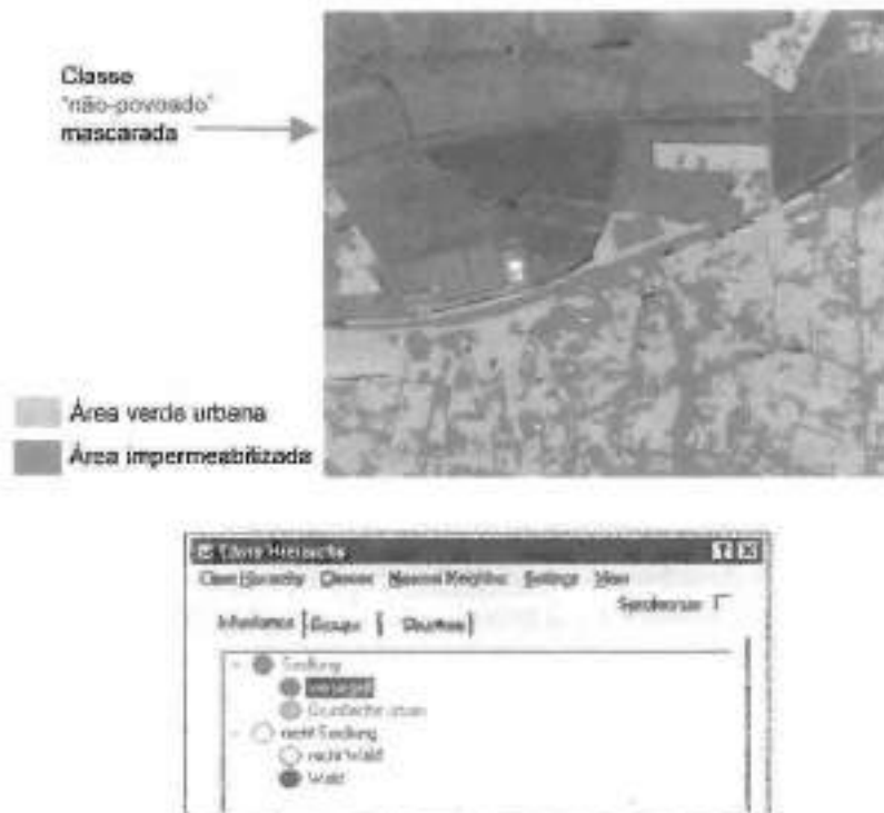
Fig. 13.5 Mascaramento com janela de dados SIG (software eCognition)
