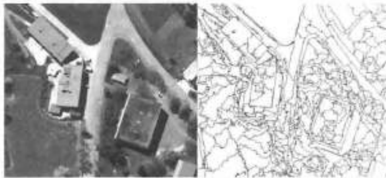
Fig. 16.3 Ortofoto original com linhas de contorno das quais foram extraídos objetos de imagem iniciais. As bordas retas dos prédios e ruas formam um nítido contraste com os objetos naturais
