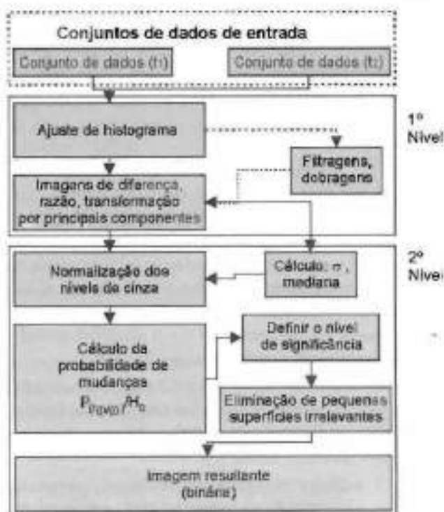
Fig. 17.3 Seqüência esquemática do procedimento automático.
