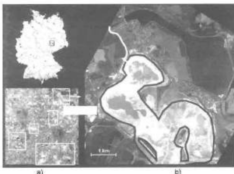
Fig. 6.2 a) Visão de conjunto das regiões de extração de linhita a céu aberto na Alemanha Central (□). (Base de dados, imagem Landsat-TM de 1989); b) Principais furos restantes da extração a céu aberto Goitsche com o nível final de enchimento com água de 75 m snm. (—). (Base de dados: cena do sensor CASI de 29.06.1998)
