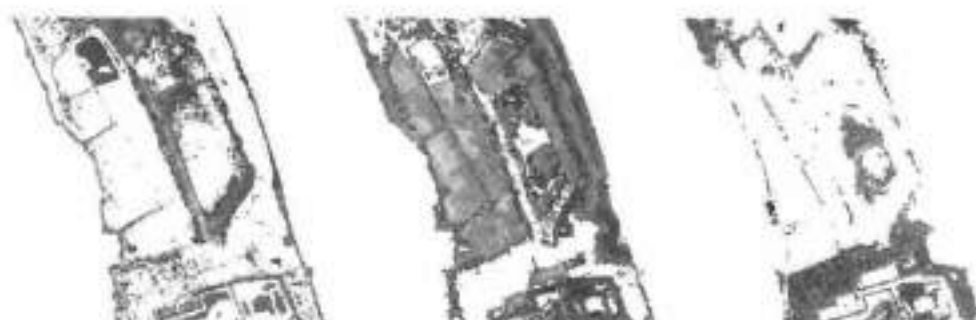
Fig. 23.1 Discriminação das informações com a ajuda de índices em máscaras e de um limiar alométrico; exemplo de uma seção da ilha Pagensand (rio Elbe). [Esquerda: não-vegetação; centro: vegetação baixa (<12 m); direita: vegetação alta]
