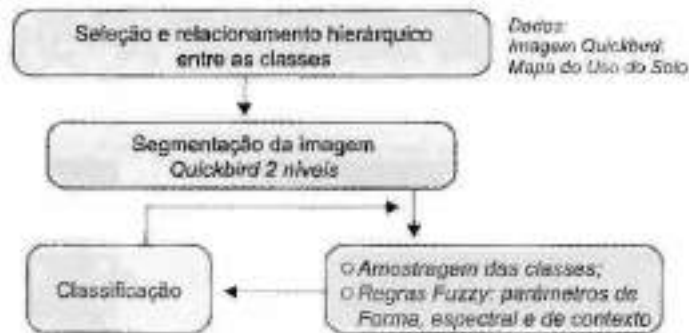
Fig. 18.4 Fluxograma do método proposto (Adaptado de Antunes, 2003)
