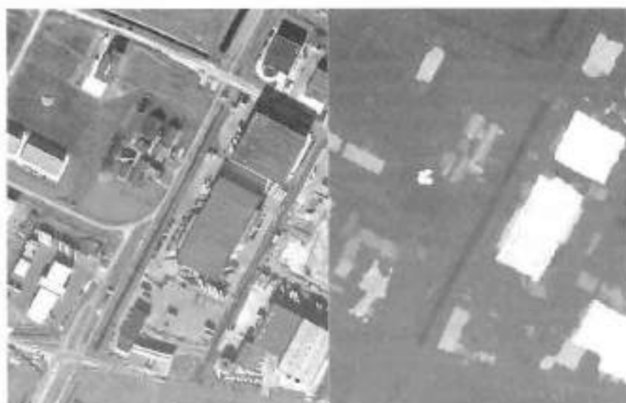
Fig. 11.7 Orto-ímagem pancromática e modelo digital de superfície
