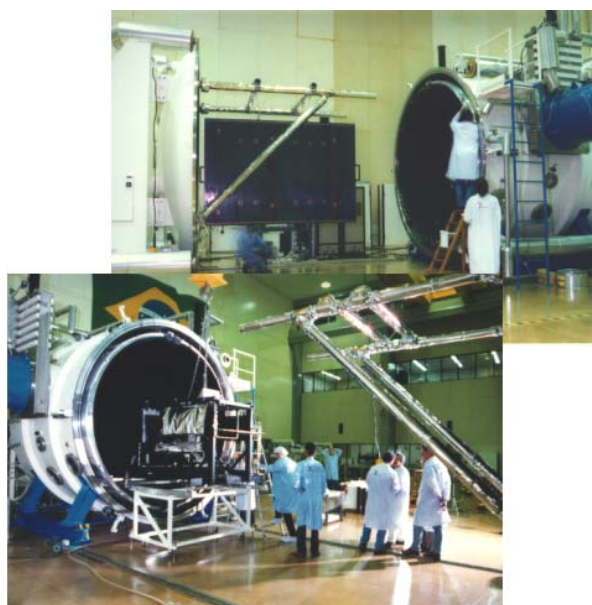
FIGURA 5.5 - Diferentes sistemas espaciais durante a etapa de qualificação do teste termovácuo.
