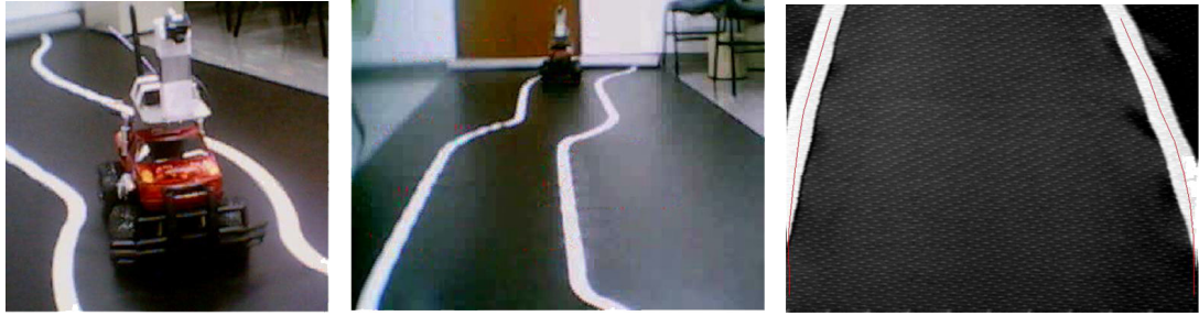
(a) Robô e sua câmera montada. (b) Imagem do veículo posicionado no ponto inicial da pista. (c) A respectiva imagem capturada da pista.
