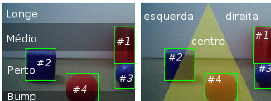
(a) Faixas horizontais que representam regiões de distância de alvos até o robô. Os objetos #1 #2 e #3 estão perto e o objeto #4 está próximo a colisão. (b) Regiões esquerda , centro e direita que representam a orientação dos objetos. Os centróides são representados pelos pontos vermelhos.
