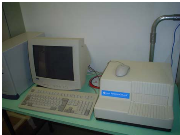
FIGURA 3.11: Leitor de ELISA SpectraCount®.
