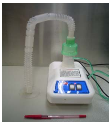
FIGURA 3.3: Nebulização da solução contendo nano partículas de prata sobre o filme de DLC.
