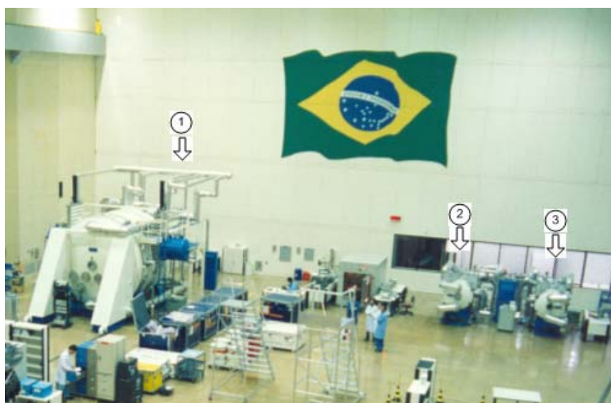
FIGURA 5.2 - Câmaras de teste termovácuo do Laboratório de Integração e Testes (LIT) no INPE.
