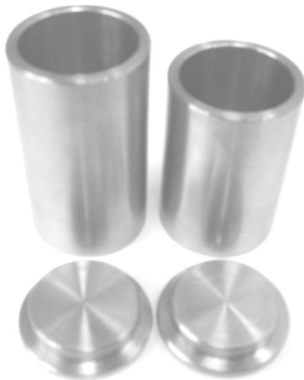
Figura 3.5 - Cadinho de aço inoxidável 304 com altura de 60 mm (ou 50 mm), diâmetro interno de 28 mm e espessura de parede de 3 mm.
