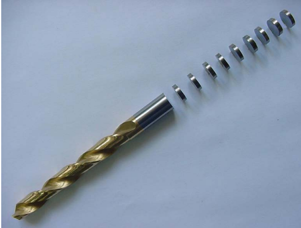
Figura 3.1 - Broca de WC-Co, grau ISO K10, com 10 mm de diâmetro cortada em fatias com 2 mm de espessura usando equipamento de corte com disco de diamante, modelo 650 da fabricante SBT (South By Technolog. Inc).
