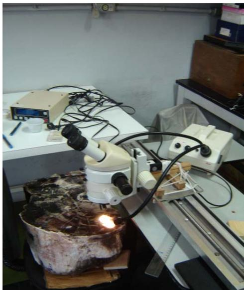
**Figura 3.17:** Mesa de mensuração marca Lintab III, com deslocamento horizontal e precisão de 1/100 mm, e sistema de iluminação de fibra ótica – Leica modelo KL 1500.
