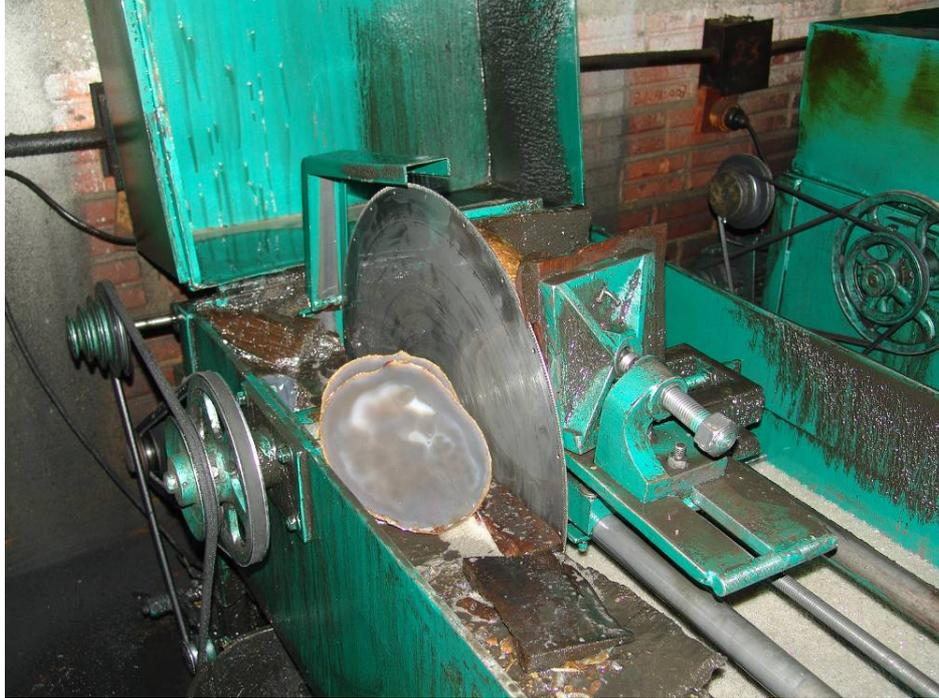
**Figura 3.16:** Disco adiamantado onde foram realizados os cortes das amostras.
