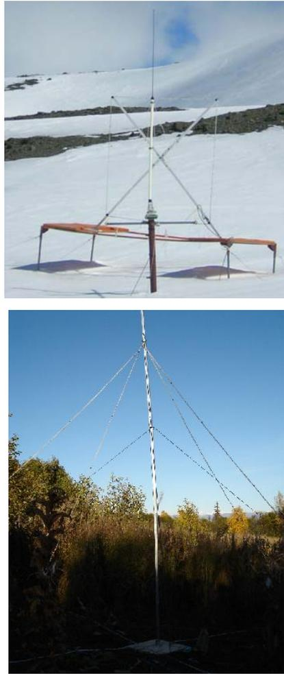
Figura 1.12 - Exemplos de antenas de VLF em 'loop': quadrada (acima) instalada na EACF, e triangular (abaixo) instalada atualmente no Rádio Observatório de Itapetinga.
