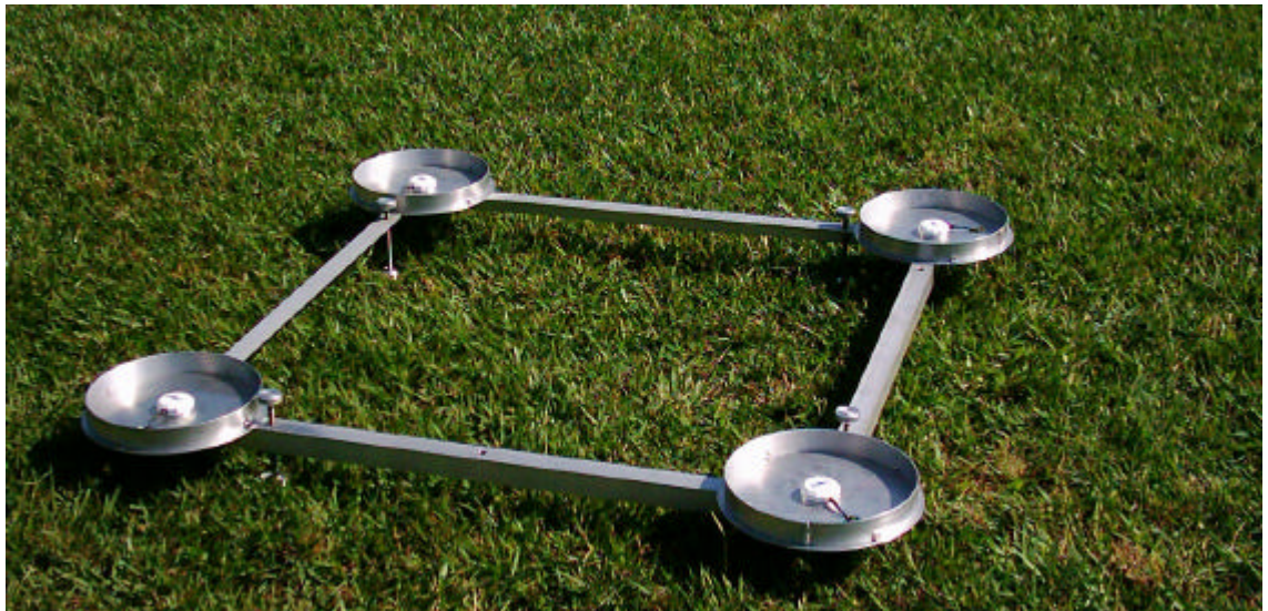
FIGURA 4.30 – Fixação das antenas na Subestrutura.
