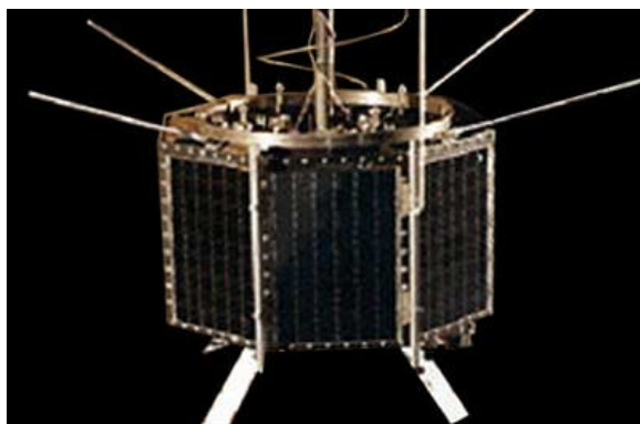
FIGURA 1.3 – Missão RADCAL, primeiro experimento utilizando GPS para atitude a bordo.
