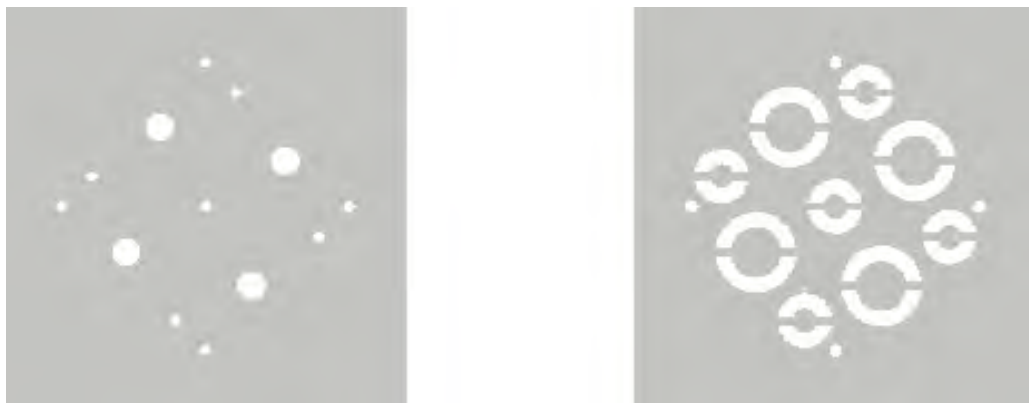
FIGURA 5.11 – Máscaras de aço inox utilizadas na deposição de Au por feixe de elétrons. A máscara da esquerda é para o topo da mesa, enquanto a da direita destina-se à base. Escala 4:1.
