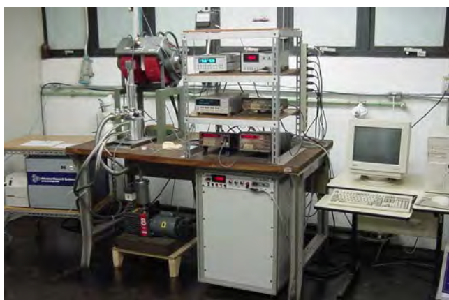
FIGURA 4.5 – Sistema de medição de resistividade e efeito Hall dependente com a temperatura.
