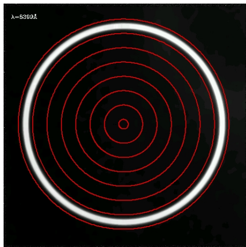
(a) Imagem obtida com o monocromador na posição espectral 8399 \text{ \AA} .
