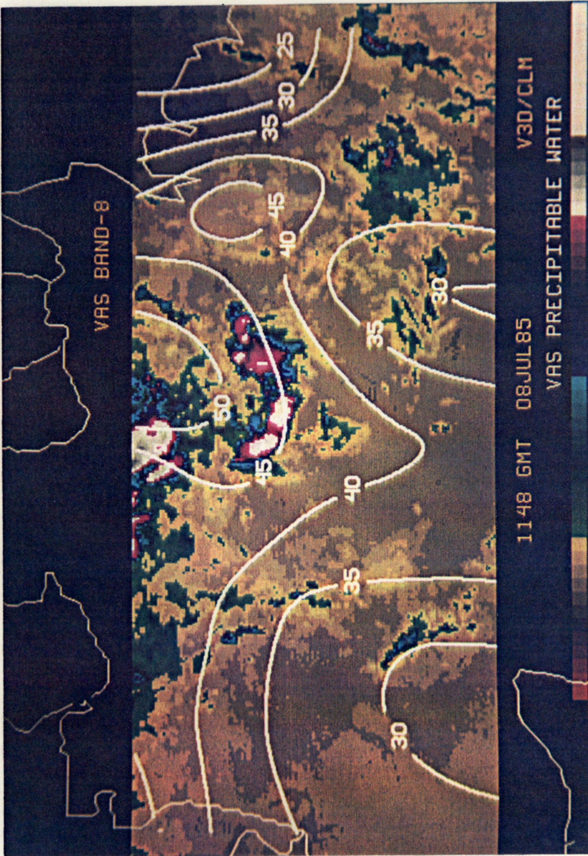
Fig. 10.26 - Caso Amazônia : análise do campo de água precipitável (mm), calculado por meio do ALG03D/RAP com estimativa inicial climatológica, sobreposta à imagem de cobertura de nuvens no canal 8 do VAS e realçada em cores no-McIDAS (11:48 IMG).
